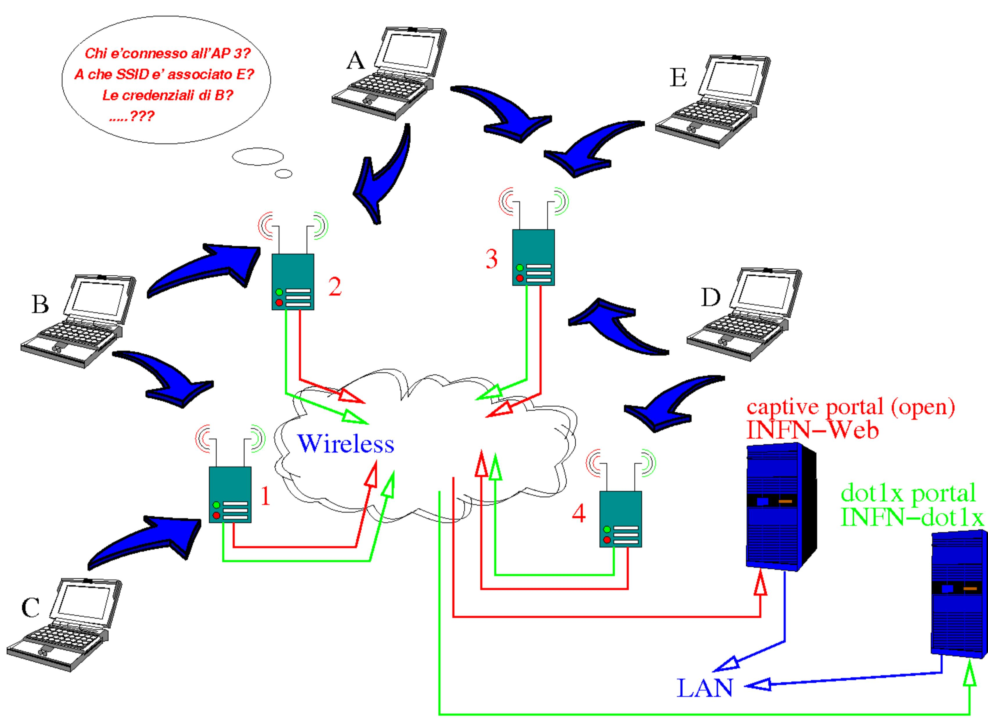
EYAWKAYWN (aka EYA) e' un semplice ed efficace sistema di controllo e visualizzazione degli accessi ad una rete wireless TRIP-compliant basata su access point Cisco, ma facilmente, almeno in linea di principio (essendo basato solo su SNMP e strumenti open-source), adattabile ad H/W di altro tipo.
