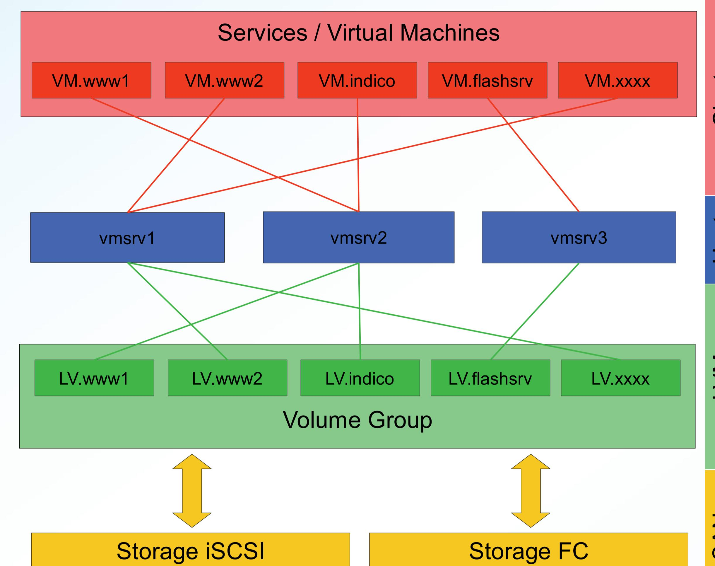
La disposizione delle macchine virtuali viene amministrata tramite RGManager il quale è in grado di far partire, di controllare lo stato e fermare i servizi nonché creare dipendenze tra un servizio e uno storage.
