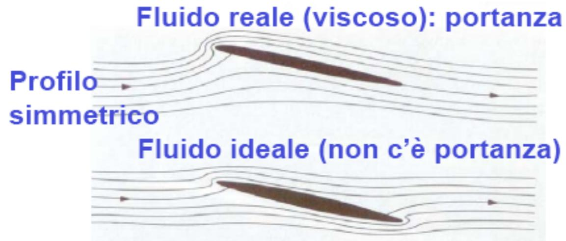
curvatura delle linee di flusso del liquido viscoso sul profilo
