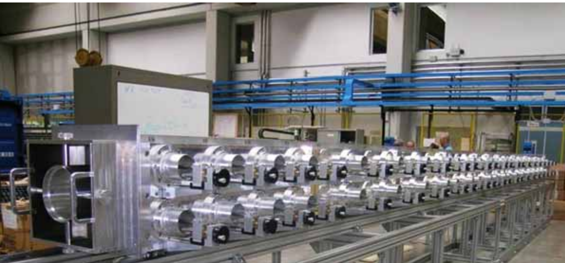
Fig. 4.12: Modello in alluminio, scala 1:1, dell'acceleratore RFQ (Radio Frequency Quadrupoli) per IFMIF, l'infrastruttura per lo studio dei materiali per i reattori a fusione.
