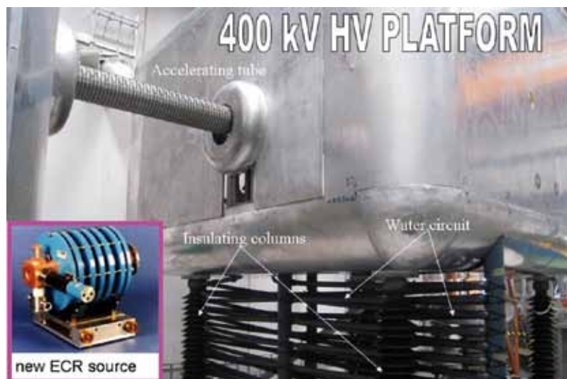
Fig. 4.11: La nuova sorgente ECR (Electron Cyclotron Resonance) dell'iniettore PIAVE, ai Laboratori Nazionali di Legnaro.
