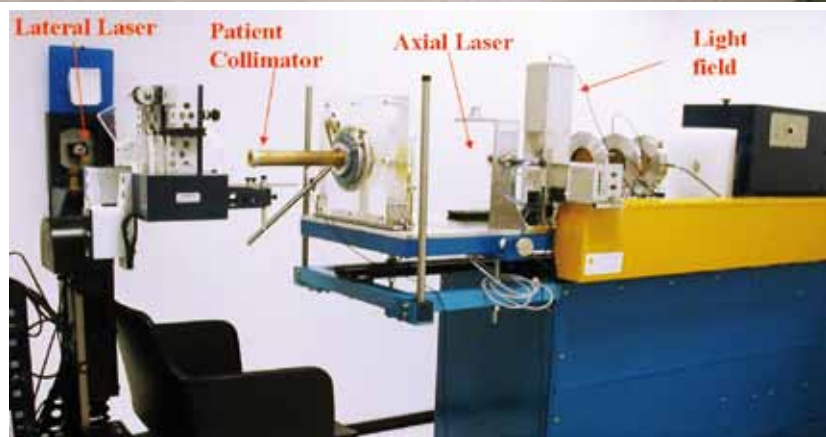
Fig. 4.19: Particolare della linea di fascio CATANA per la terapia del melanoma oculare.
