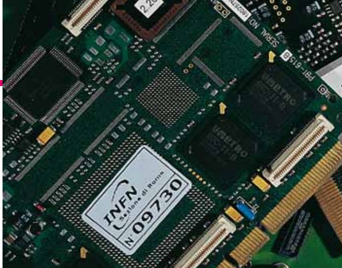
Fig. 3.19: Scheda del supercomputer APE: le unit di calcolo che operano in parallelo ne garantiscono le alte prestazioni.
