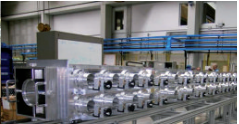
Fig. 4.13: Il modello in alluminio, scala 1:1, dell'acceleratore RFQ per IFMIF.
