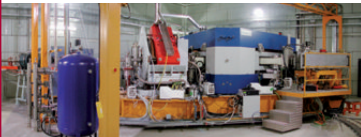
Fig. 4.22: Lo spettrometro magnetico MAGNEX ai Laboratori Nazionali del Sud.
