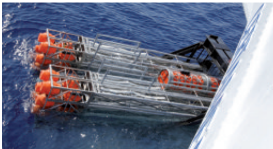
Fig. 4.29: Deployment di un prototipo meccanico della torre NEMO
